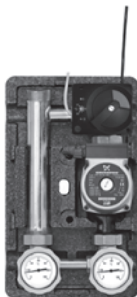
Смесительная группа с электронным термостатом и смесителем для поддержания температуры обратной линии
