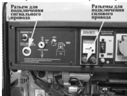
Разъемы подключения на панели генератора. Рис.1
