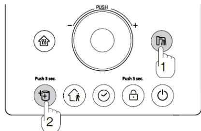
Режим «Антилегионелла» доступен только при подключенном бойлере.
