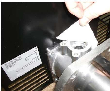
2) повернуть Горелка и Снять заглушку;
