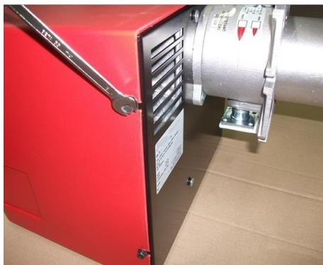
1) Снять кожух, ослабив 4 винта;
