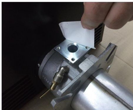
2) повернуть Горелка и Снять заглушку;
