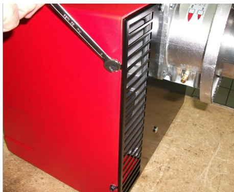
1) Снять кожух, ослабив 4 винта;
