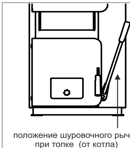
Рис.11 Установка рычагов шуровочного механизма
