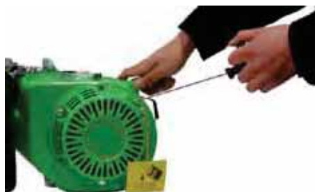
Установка поршня в ВМТ
