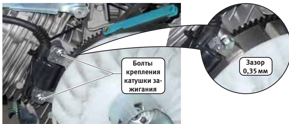
Регулирование зазора между катушкой зажигания и маховиком двигателя
