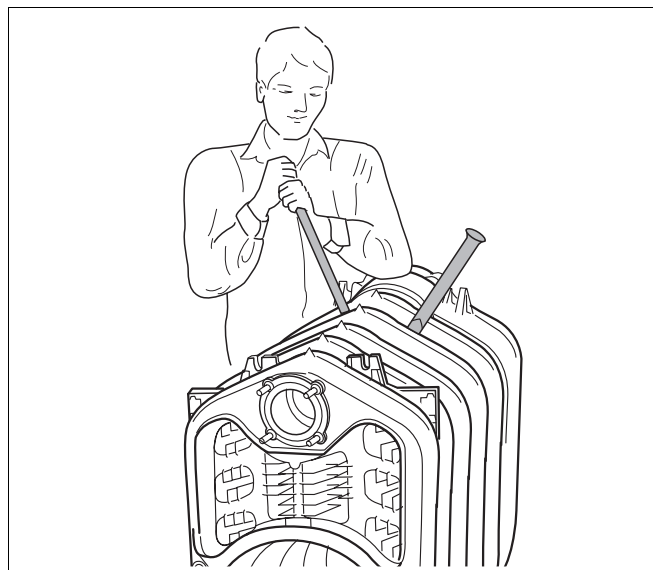
Рис. 27 Разъединение секций котла
