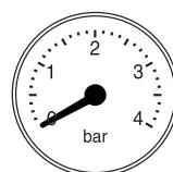
Отображает давление воды в контуре отопления; данное значение давления не должно быть ниже 0,8/1 бара (при холодной системе).
