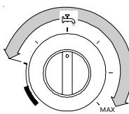
Установить рукоятку регулировки температуры воды в контуре ГВС (C) на значение необходимой температуры: режим **"CONFORT"** от 38°C до 60°C, **ECO-CONFORT** или **ECO**.
