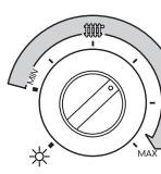
Если рукоятка регулятора находится в области, указанной на рисунке, котел работает в режиме «Зима» и регулирует температуру в контуре отопления. Регулировка происходит в диапазоне от 30°C (мин.) до 85°C (макс.).
