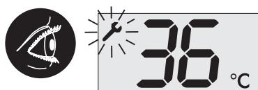
Если неисправность привела к блокировке работы котла или котел находится в режиме ожидания (stand-by), вместо значения температуры на дисплее отображается код, который идентифицирует причину неисправности (список неисправностей см. в параграфе 5 «Коды ошибок» в Инструкции по установке и обслуживанию).
